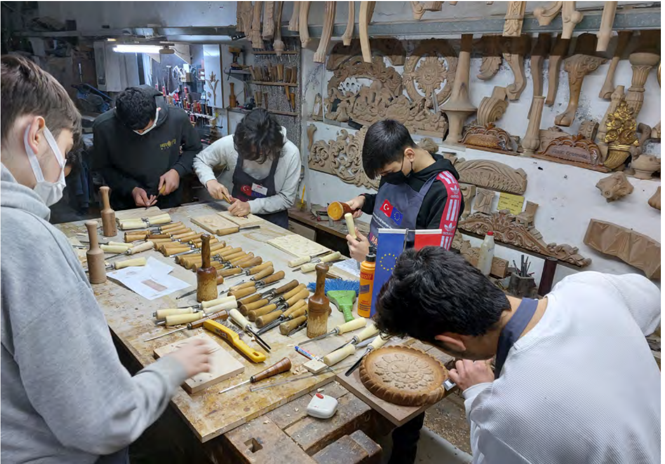
G.4.10. Çalışma tezgâhında şaşırtmalı dizilmiş iskarpelalar.
