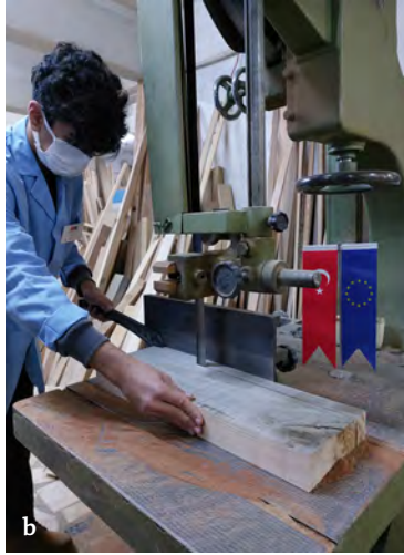
G.4.1. a. Planyada çalışma; b. şerit testerede çalışma.
